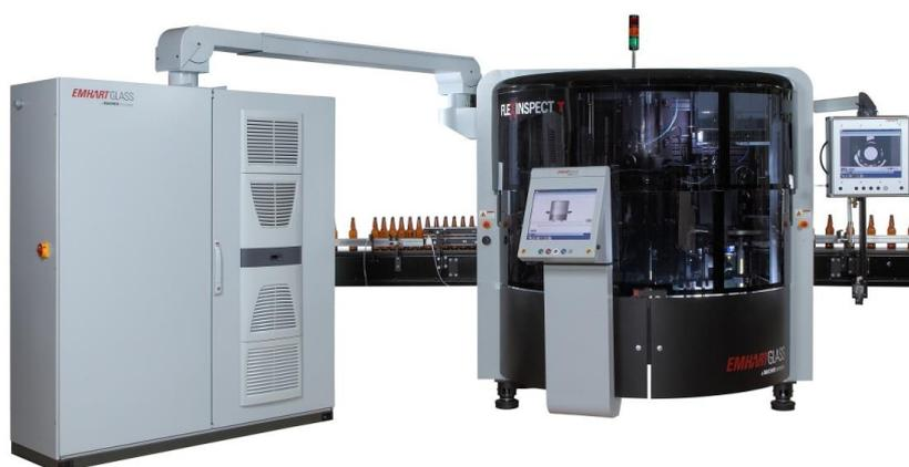
paquete de detección de grietas estándar incluye 8 sensores y 8 receptores con hasta 16 canales modulados (se pueden expandir hasta 27 canales).
